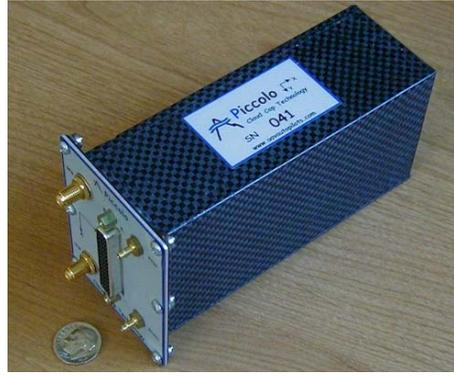
Fig. 7 Piccolo Avionics Package
