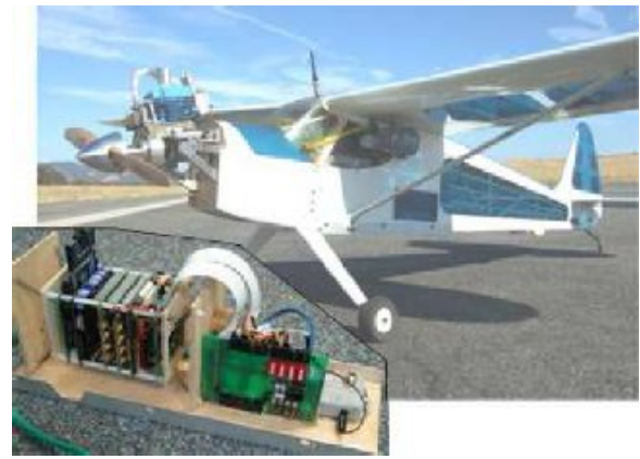
Fig. 10. UC Berkeley Sig Rascal and PC-104 Payload
